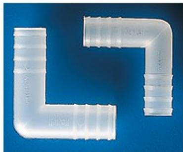
Raccordi per tubi a LMateriale: PolipropileneSono autoclavabili e conformi alle norme per l'uso con sostanze alimentari.EEC 90/128 92/93 e FDA 21 CFR 177.1520.Le dimensioni riportate sono sia nominali che esatte poiché l'elasticità dei tubi influenza la scelta del tipo di raccordo adatto.
