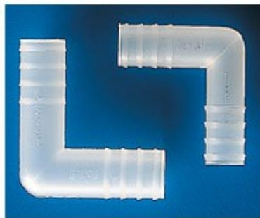
Raccordi per tubi con forma ad "L", in polipropilene. Sono autoclavabili e conformi alle norme per l'uso con sostanze alimentari EEC 90/128 92/93 e FDA 21 CFR 177.1520. Le dimensioni riportate sono sia nominali che esatte poiché l'elasticità dei tubi influenza la scelta del tipo di raccordo adatto.
