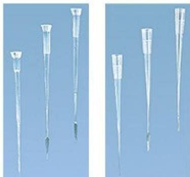
Puntali per gel loading. Per dispensare in modo ottimale i campioni nel gel sono stati realizzati degli speciali puntali molto sottili con punta allungata o a spatola.
