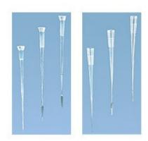
Puntali per gel loading. Per dispensare in modo ottimale i campioni nel gel sono stati realizzati degli speciali puntali molto sottili con punta allungata o a spatola. Confezione in rack da 200.
