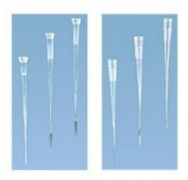
Puntali speciali per il caricamento di campioni nei gel per elettroforesi. Per dispensare in modo ottimale i campioni nel gel sono stati realizzati degli speciali puntali molto sottili con punta allungata a cono o piatta, a spatola, con foro di due diametri diversi.
