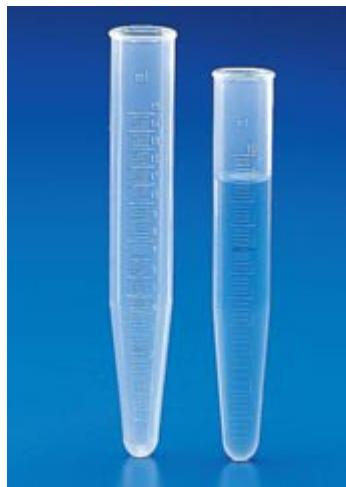
Provette coniche in polipropilene. Sterilizzabili in autoclave fino a 120 °C. Con o senza graduazione. .
