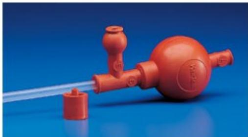
Pompette in gomma rossa con tre valvole sferiche in vetro, adattabili a qualsiasi pipetta. Uno speciale raccordo di gomma consente di usare la pompetta con pipette aventi capacità superiore a 20 ml. Staccando tale raccordo, la pompetta si adatta alle pipette con capacità inferiore a 20 ml.
