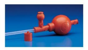
Pompette in gomma rossa con tre valvole sferiche in vetro, adattabili a qualsiasi pipetta. Uno speciale raccordo di gomma consente di usare la pompetta con pipette aventi capacità superiore a 20 ml. Staccando tale raccordo, la pompetta si adatta alle pipette con capacità inferiore a 20 ml.
