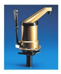
Pompa dispensatrice per liquidi viscosi, realizzata in polipropilene. Può travasare liquidi molto viscosi (pari a olio SAE 90). Comando a leva che permette l'erogazione di 22÷23 litri al minuto. Mandata di circa 300 ml per corsa del pistone. Beccuccio di erogazione orientabile su 360°.
