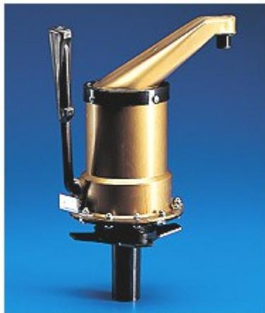
Pompa dispensatrice per liquidi viscosi, realizzata in polipropilene. Può travasare liquidi molto viscosi (pari a olio SAE 90). Comando a leva che permette l'erogazione di 22÷23 litri al minuto. Mandata di circa 300 ml per corsa del pistone. Beccuccio di erogazione orientabile su 360°. .
