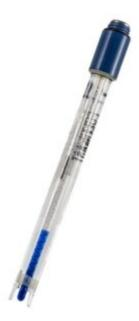
Elettrodo di pH combinato, corpo in epoxy infrangibili. Elettrodi a basso costo con buona resistenza chimica adatti a campioni che possono contaminare i normali diaframmi. Riempimento a polimero un setto poroso aperto e uno ceramico. Esenti da manutenzione. Testa a vite S7, senza cavo. .
