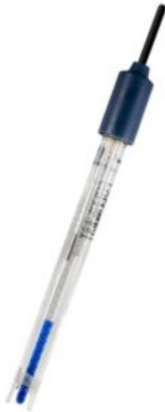
Caratteristiche: con corpo in epoxy infrangibile. Buona resistenza chimica. Dimensioni (LxØ) mm 120x12. Riempimento a polimero un setto poroso aperto ed uno ceramico, per una risposta veloce con elevata precisione in campioni che possono contaminare i normali diaframmi. Esente da manutenzione. .
