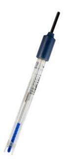
Caratteristiche: con corpo in epoxy infrangibile. Buona resistenza chimica. Dimensioni (LxØ) mm 120×12. Riempimento a polimero un setto poroso aperto ed uno ceramico, per una risposta veloce con elevata precisione in campioni che possono contaminare i normali diaframmi. Esente da manutenzione.
