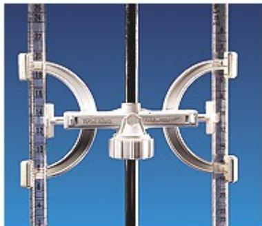
Pinze per burette in polipropilene. Sono state realizzate con attacco per aste con diametro da 8 a 14 mm e con gommini di bloccaggio delle burette. Una volta montata, la buretta non viene coperta dai bracci di sostegno per cui la graduazione e il menisco sono facilmente visibili per tutta la lunghezza della buretta. Provviste di molla in acciaio inox.
