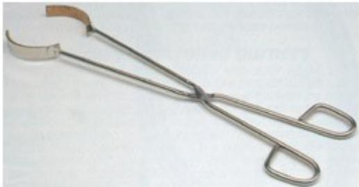
Caratteristiche: In acciaio inox con rivestimento delle branche in sughero. Adatta alla presa di bicchieri con diametro tra 50 e 80 mm. Lunghezza mm. 320. .
