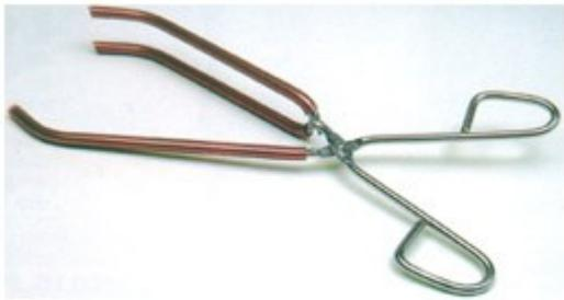
Caratteristiche: In acciaio inox. rivestita in PVC. lunghezza 280 mm. adatte a beaker da 100 ml a 1500 ml. .
