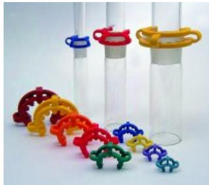
Caratteristiche: In poliacetato antiacido (POM). Temperatura massima di utilizzo 150°C. Temperatura massima di fusione 175°C. .
