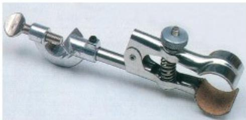
Caratteristiche: In acciaio inox 18/8 Branche rivestite in sughero Lunghezza 120 mm. Per aste fino a 16 mm. di diametro .
