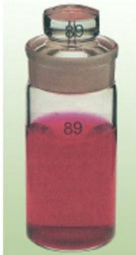
Caratteristiche: Per determinazione peso specifico del catrame o liquidi viscosi a norme ASTM D 70/52 con tappo smerigliato forato .
