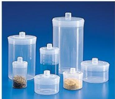
**Pesafiltri** Materiale: Polipropilene. Questi contenitori leggeri, autoclavabili, riutilizzabili riducono le correzioni dovute alla tara nelle pesate di precisione; completi di coperchio a pressione a tenuta d'aria. Ottima resistenza agli acidi. Il bordo superiore può essere schiacciato per facilitare il versamento dei liquidi. Togliere il coperchio prima dell'autoclavaggio.
