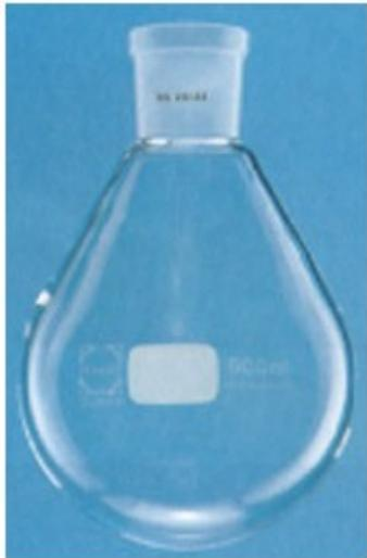
Palloni per evaporatore rotante in vetro Duran® con cono normalizzato secondo norme ISO. Forma a pera, spessore robusto, ideali per uso sottovuoto. .
