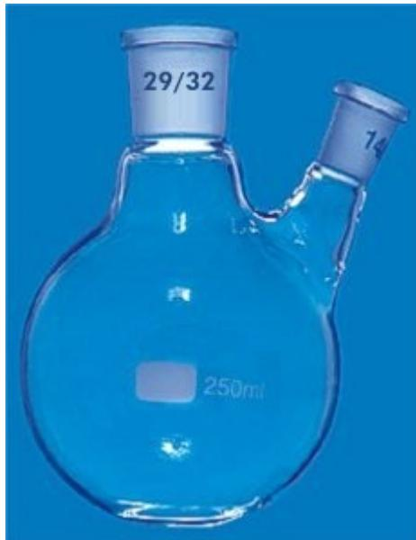
Palloni con sfondo sferico in vetro borosilicato Pyrex® o Duran® resistente agli sbalzi termici e agli agenti aggressivi, con 2 colli con cono smerigliato secondo le norme ISO. Il collo laterale è angolato e il suo asse incontra l'asse del collo centrale sul fondo del pallone.
