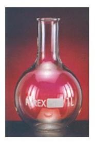
Caratteristiche: Fondo piano a collo normale di media lunghezza, orlo svasato. In vetro borosilicato Pyrex? o Duran? resistente agli sbalzi termici e agli aggressivi chimici. Secondo DIN 12 347 ISO 1773.
