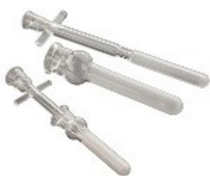
Caratteristiche: Omogeneizzatori di precisione, con pestello e mortaio intercambiabili Progettati per essere usati manualmente o con agitatori a bassa velocità. Particolarmente indicati per tessuti quali fegato, intestino e cuore. Il mortaio è dotato di serbatoio, nel pestello cavo può essere inserito del ghiaccio. Prodotti in vetro borosilicato Wheaton 33?. Distanza tra pestello e mortaio 0,0035" ÷ 0,0065". Confezione da 2 pezzi.
