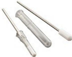
Caratteristiche: Omogeneizzatori Potter-Elvehjem con pestello in PTFE. Particolarmente indicati per tessuti molli quali cervello e fegato. I mortai degli omogeneizzatori Potter-Elvehjem sono prodotti in vetro borosilicato Wheaton3? e le unità sono interamente autoclavabili. Distanza tra pestello e mortaio 0,004" ÷ 0,006". Confezione da 2 pezzi.
