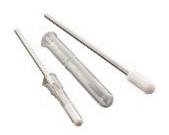
Caratteristiche: Omogeneizzatori Potter-Elvehjem con pestello in PTFE. Particolarmente indicati per tessuti molli quali cervello e fegato. I mortai degli omogeneizzatori Potter-Elvehjem sono prodotti in vetro borosilicato Wheaton33? e le unità sono interamente autoclavabili. Distanza tra pestello e mortaio 0,004" ÷ 0,006". Confezione da 2 pezzi.
