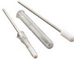
Caratteristiche: Omogeneizzatori Potter-Elvehjem con pestello in PTFE. Particolarmente indicati per tessuti molli quali cervello e fegato. I mortai degli omogeneizzatori Potter-Elvehjem sono prodotti in vetro borosilicato Wheaton3? e le unità sono interamente autoclavabili. Distanza tra pestello e mortaio 0,004" ÷ 0,006". Confezione da 2 pezzi.
