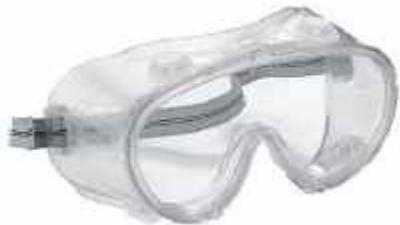
Caratteristiche: A mascherina in PVC Montatura trasparente: 3 4 9 BT Monolente con trattamento antigraffio e antiappannante: 1 BT 9 4 valvole di aerazione Fascia elastica regolabile Secondo UNI-EN 166
