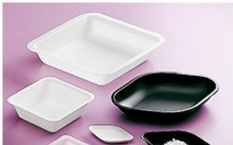
Navicelle per pesata da utilizzare per eseguire con facilità pesate di precisione. Non sono contaminanti (HIPS idrofobico) e si deformano con facilità a forma di imbuto. Colore bianco.
