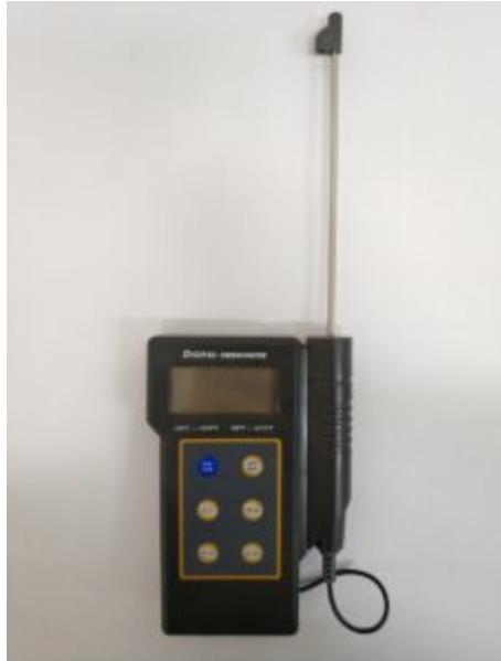
Termometro elettronico digitale per rilevamento della temperatura massima e minima. Selettore per letture in °C o °F. Dotato di allarme sonoro quando la temperatura eccede dai livelli minimi e massimi impostati. Fornito con sonda di penetrazione in acciaio inox lunghezza mm 145, diametro mm 3,5 e cavo PTFE lungo 1 mt.
