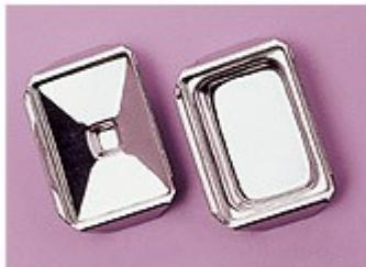
Realizzati in acciaio inossidabile con superficie lucida per facilitare il distacco delle inclusioni in paraffina.
