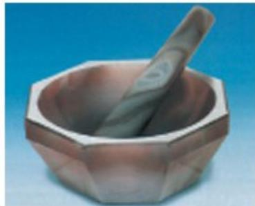
Caratteristiche: In agata di forma ottagonale con pareti spesse e resistenti. Forniti completi di pestello.
