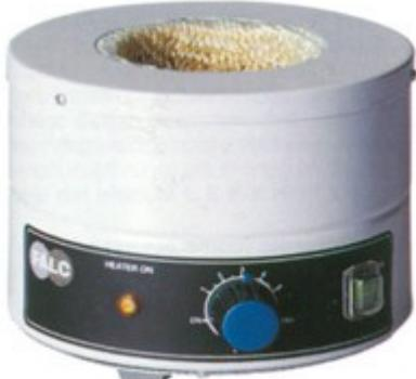
Mantello riscaldante semirigido serie MM per palloni da litri 2La custodia esterna è in acciaio verniciate con polvere epossidica antiacida, il nido semirigido che si adatta alla forma del pallone riducendo completamente il rischio della rottura del pallone. Dispone anche dell'isolamento termico composto da una fibra di ceramica e le temperature sono controllate da un termoregolatore con scala numerata. Tutti i riscaldatori sono dotati da un interruttore ON / OFF con luce verde. .
