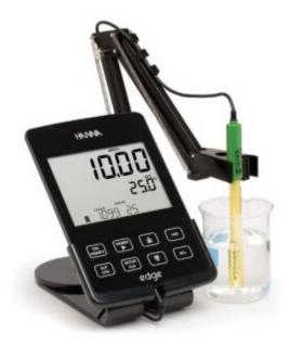
Lo strumento multiparametro **EDGE® pH-EC-DO** utilizza speciali elettrodi digitali dotati di microchip interno, che memorizza informazioni quali: tipo di sensore, serial number e dati di calibrazione.
