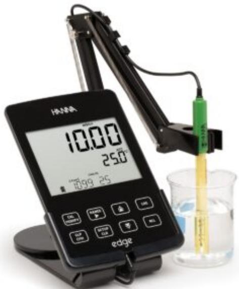
Lo strumento multiparametro **EDGE® pH-EC-DO** utilizza speciali elettrodi digitali dotati di microchip interno, che memorizza informazioni quali: tipo di sensore, serial number e dati di calibrazione.
