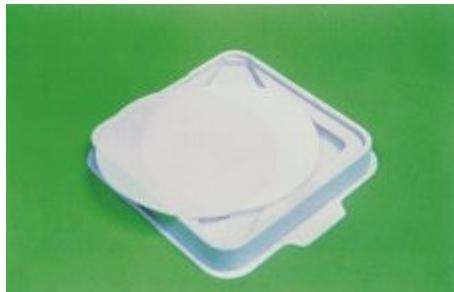
Caratteristiche principali: Offrono un livello di assorbimento specifico di proteine più basso rispetto alle versioni in nitrato di cellulosa o cellulose rigenerate e sono la scelta appropriata per gli studi biologici. Hanno un'elevata resistenza termica ed a solventi, particolarmente agli alcoli di basso peso molecolare e sono in grado di tollerare ripetute sterilizzazioni a vapore con integrità ed efficacia inalterata. Disponibili anche altri formati e porosità diverse.
