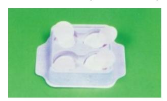
Caratteristiche principali: Possiedono una struttura cellulare aperta a poro largo. Le particelle vengono catturate nella struttura stessa della membrana anziché ritenute sulla superficie. Limite max della temperatura 180° C. Autoclavabili a 121 o 134° C.
