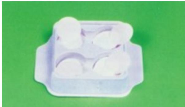
Caratteristiche principali: Possiedono una struttura cellulare aperta a poro largo. Le particelle vengono catturate nella struttura stessa della membrana anziché ritenute sulla superficie. Limite max della temperatura 180° C. Autoclavabili a 121 o 134° C.
