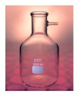
Caratteristiche principali: Pareti spesse per una migliore resistenza al vuoto. Connettore ad oliva per tubi di raccordo flessibile. Conforme alla norma ISO 6556.
