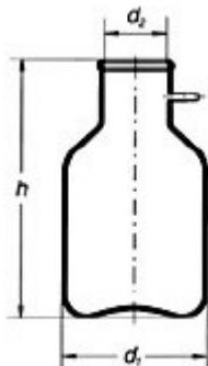
Caratteristiche principali: Pareti spesse per una migliore resistenza al vuoto. Connettore ad oliva per tubi di raccordo flessibile. Conformi alla norma ISO 6556.
