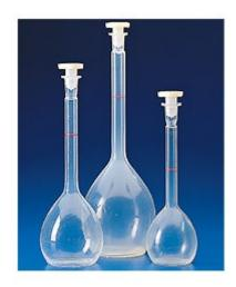
Matracci in PMP (TPX®), tarati con tappo.Perfettamente trasparenti, sono del tutto privi di menisco e quindi permettono una facile lettura; sono tarati con metodo gravimetrico a +20° C in Classe B, e stampati in un solo pezzo con pareti spesse per evitare distorsioni.Il collo particolarmente stretto assicura un'ottima precisione di lettura.Autoclavabili e chimicamente più puliti del vetro poiché non danno luogo a cessioni o assorbimenti.Forniti completi di tappo. .
