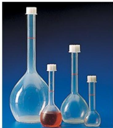
Matracci tarati con tappo a vite, realizzati in PMP (TPX®). Perfettamente trasparenti, sono del tutto privi di menisco e quindi permettono una facile lettura; sono tarati con metodo gravimetrico a +20° C in Classe B, e stampati in un solo pezzo con pareti spesse per evitare distorsioni. Il collo particolarmente stretto assicura un'ottima precisione di lettura. Autoclavabili e chimicamente più puliti del vetro poiché non danno luogo a cessioni o assorbimenti. Forniti completi di tappo. .
