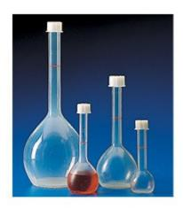
Matracci tarati con tappo a vite, realizzati in PMP (TPX®).Perfettamente trasparenti, sono del tutto privi di menisco e quindi permettono una facile lettura; sono tarati con metodo gravimetrico a +20° C in Classe B, e stampati in un solo pezzo con pareti spesse per evitare distorsioni.Il collo particolarmente stretto assicura un'ottima precisione di lettura.Autoclavabili e chimicamente più puliti del vetro poiché non danno luogo a cessioni o assorbimenti.Forniti completi di tappo. .
