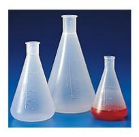
Matracci conici di ErlenmeyerMateriale: PolipropilenePer usi generali di laboratorio, autoclavabili. La dimensione del collo è standardizzata.
