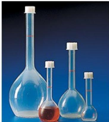
Matracchi tarati con tappo a vite. Materiale: PMP (TPX®). Perfettamente trasparenti, sono del tutto privi di menisco e quindi permettono una facile lettura; sono tarati con metodo gravimetrico a +20°C in Classe B e stampati in un solo pezzo con pareti spesse per evitare distorsioni. Il collo particolarmente stretto assicura un'ottima precisione di lettura. Autoclavabili e chimicamente più puliti del vetro poiché non danno luogo a cessioni o assorbimenti. Forniti completi di tappo.
