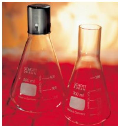
Caratteristiche principali: Collo diametro esterno mm 38, con graduazione. Per tappi in cotone, in spugna o capsule metalliche.
