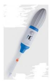
Caratteristiche: Dispositivo manuale per riempimento pipette da 1 ml a 100 ml. Si adatta comodamente alla mano, consentendo il controllo regolare sia in aspirazione che in erogazione. Prima si preme il bulbo in silicone e la leva del pollice controlla sia l'aspirazione che la dispensazione. Il bottone centrale incorporato spinge fuori il liquido rimasto nella pipetta. .
