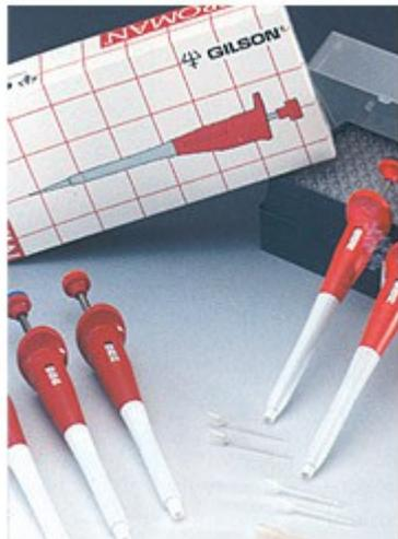
Le micropipette a spostamento positivo utilizzano speciali puntali con pistoni. I capillari sono costituiti da un tubicino rigido calibrato di differenti misure. I capillari e pistoni per M10 e M100 sono preassemblati e posizionati in vassoi da 96 pezzi, facili da manipolare. Essi si fissano sulla pipetta senza contatto manuale. Il processo di fabbricazione e l'imballaggio automatico proteggono dalla contaminazione da nucleasi o da acidi nucleici.
