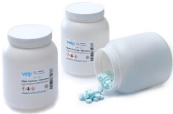
Le KjTabs™ VS Antischiuma sono perfette per ridurre la formazione di schiuma durante la fase iniziale del processo di mineralizzazione.
