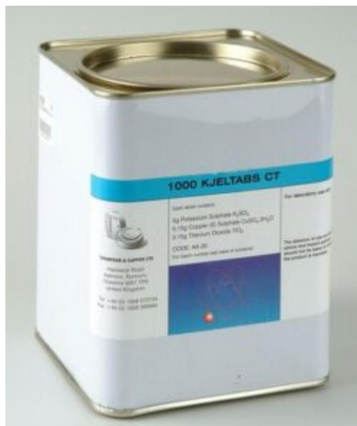
Prodotti studiati per semplificare le operazioni analitiche mantenendo un'elevata riproducibilità. Pastiglie catalizzatrici per accelerare, semplificare e standardizzare le mineralizzazioni ossidative nelle analisi di azoto secondo Kjeldahl. Sono confezionate in pastiglie preosate per evitare errori e velocizzare il procedimento analitico.
