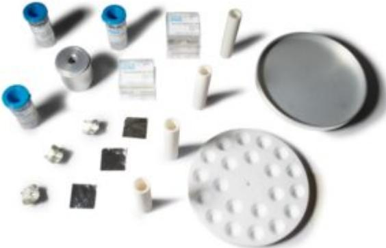
Progettato per ottimizzare l'analisi del Carbonio Organico Totale (TOC), questo kit fornisce tutti i componenti essenziali per la fase di acidificazione, garantendo l'effettiva rimozione del carbonio inorganico dal campione prima della determinazione del TOC.
