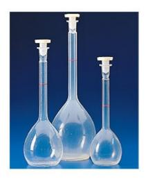
Matracci tarati con tappoMateriale: PMP (TPX®)Perfettamente trasparenti, sono del tutto privi di menisco e quindi permettono una facile lettura; sono tarati con metodo gravimetrico a +20°C in Classe B e stampati in un solo pezzo con pareti spesse per evitare distorsioni.Il collo particolarmente stretto assicura un'ottima precisione di lettura.Autoclavabili e chimicamente più puliti del vetro poiché non danno luogo a cessioni o assorbimenti.Forniti completi di tappo. .
