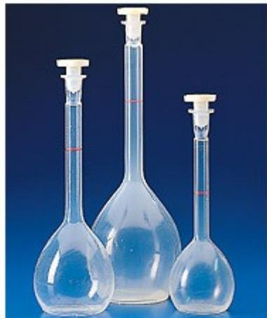
Matracchi tarati con tappo. Materiale: PMP (TPX®). Perfettamente trasparenti, sono del tutto privi di menisco e quindi permettono una facile lettura; sono tarati con metodo gravimetrico a +20°C in Classe B e stampati in un solo pezzo con pareti spesse per evitare distorsioni. Il collo particolarmente stretto assicura un'ottima precisione di lettura. Autoclavabili e chimicamente più puliti del vetro poiché non danno luogo a cessioni o assorbimenti. Forniti completi di tappo. .
