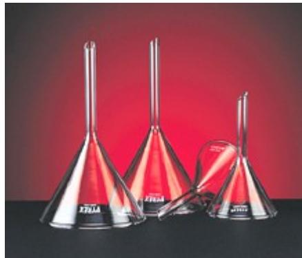
Caratteristiche: Resistenti al calore e agli aggressivi chimici. Pareti con inclinazione di 60°. Secondo DIN 12445, ISO 4798.
