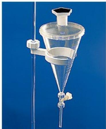
Imbuto separatore in PMP (TPX®), trasparente e con graduazione in rilievo. Sterilizzabile in autoclave. Ha un'eccellente resistenza chimica. È dotato di coperchio filettato con collo normalizzato NS 29/32 per tappo conico standard. È facilmente smontabile per la pulizia ed è dotato di rubinetto in PMP con spillo e connettori in Nylon. .
