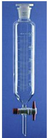
Caratteristiche: vetro borosilicato. Sono forniti di tappo in polipropilene, cono a smerigliatura normalizzata, rubinetto di scarico in PTFE e dispositivo di ritegno a vite. .
